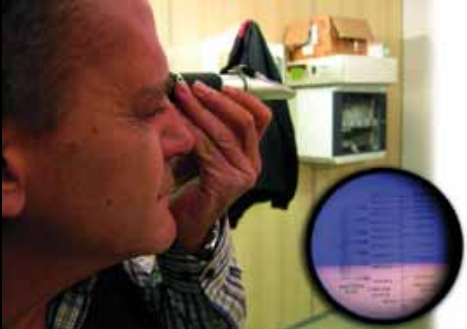
Observación mediante el refractómetro óptico de la concentración de glicol en el fluido caloportador.
