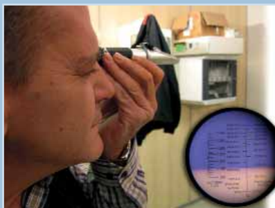
Observación mediante refractómetro óptico de la concentración de glicol en el fluido caloportador.
